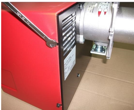
1) Снять кожух, ослабив 4 винта;
