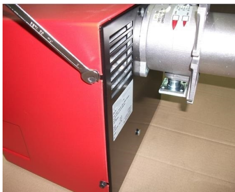
1) Снять кожух, ослабив 4 винта;
