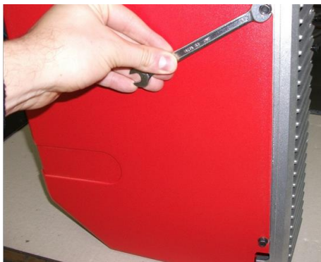
1) Снять кожух, ослабив 4 винта;
