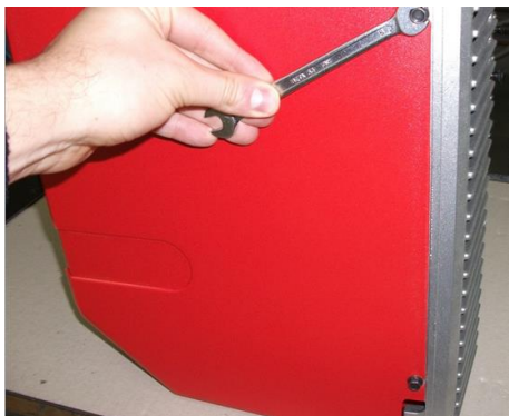
10) Снять кожух, ослабив 4 винта;
