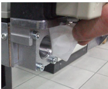
8) Снять заглушку из Труба ГАЗОВОЙ рампы;
