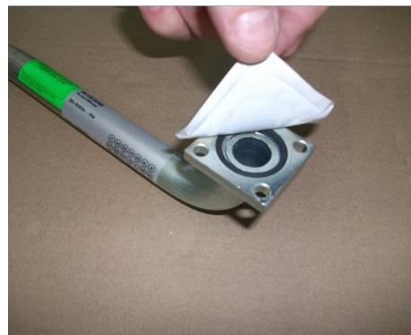
3) Снять заглушку из Труба ГАЗОВОЙ рампы и удостовериться, что прокладка фланца рампы установлена в правильном положении;
