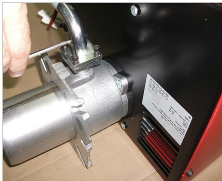
4) Прикрепить Труба ГАЗОВОЙ ramпы в фланец при помощи 4-х винтов с цилиндрической головкой;
